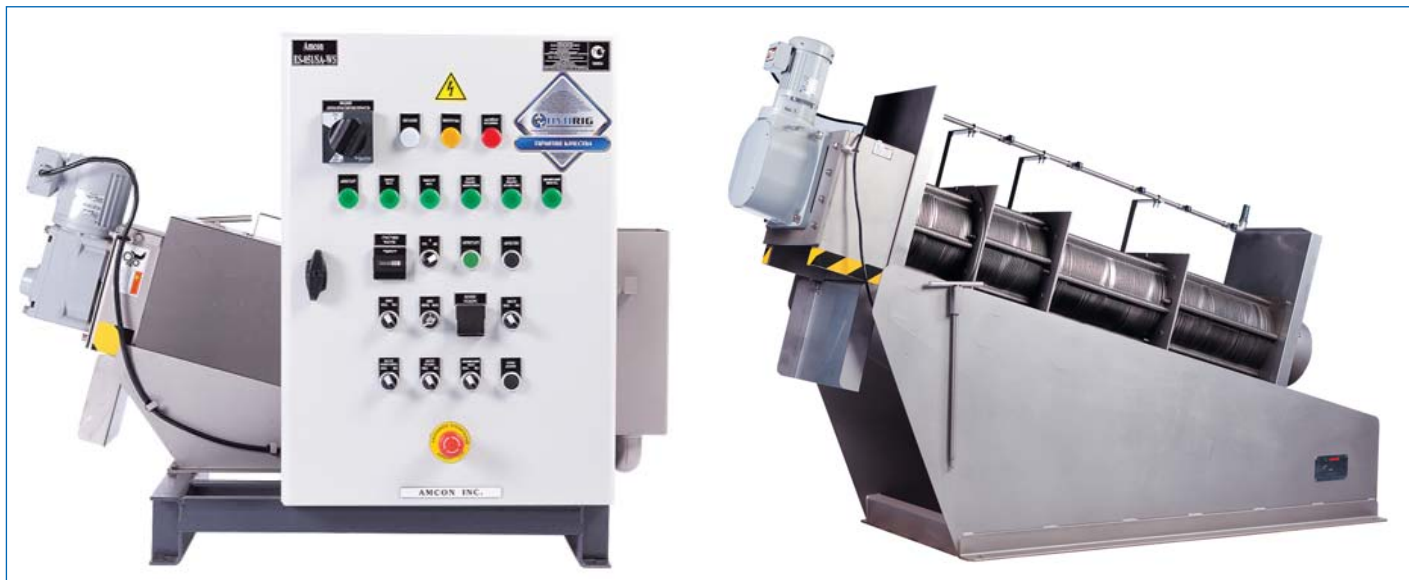
■ Рис. 3. Устройство механического обезвоживателя осадка AMCON ES-051
